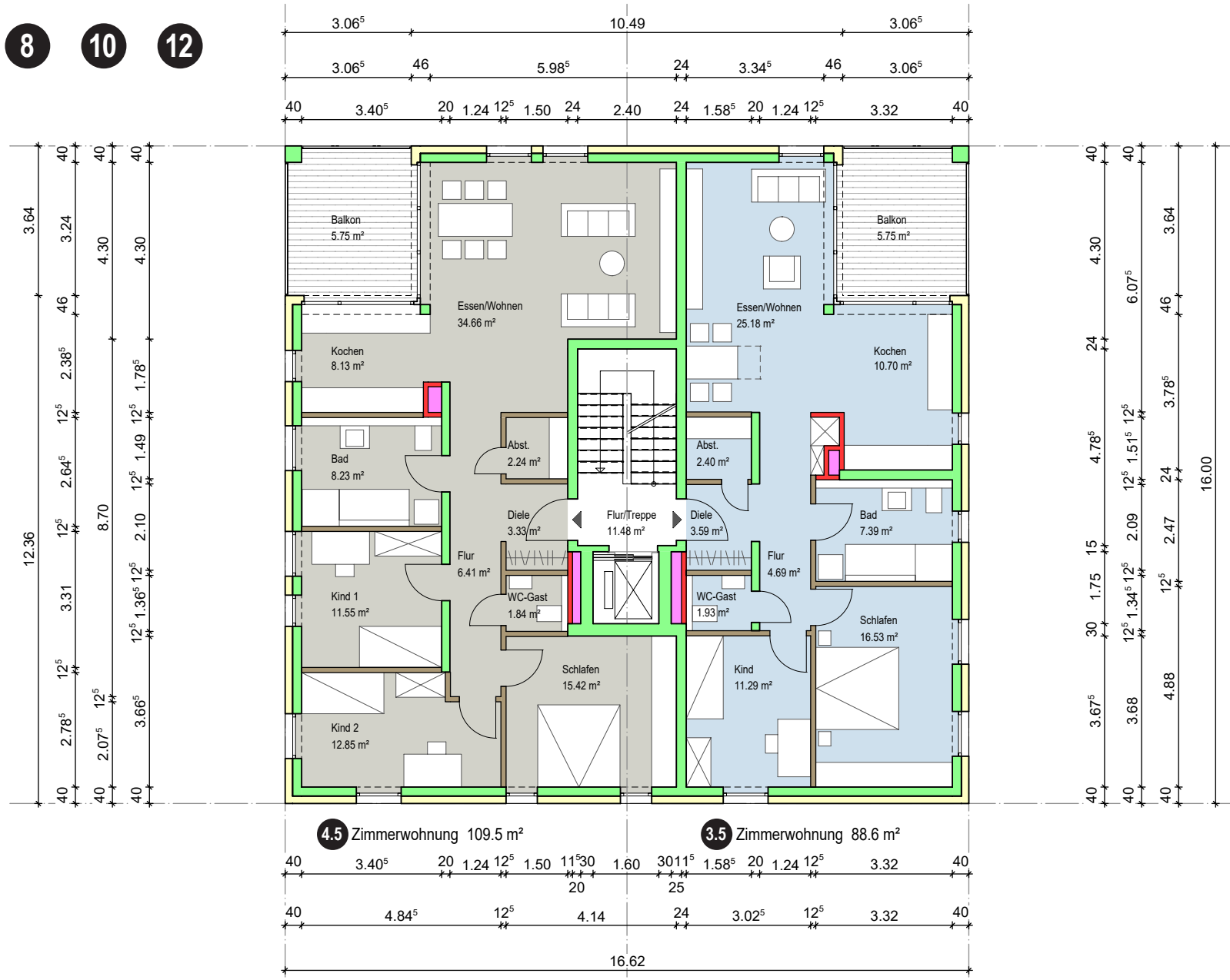
GRUNDRISS 3.OBERGESCHOSS (nur 4-geschossiges Gebäude)
